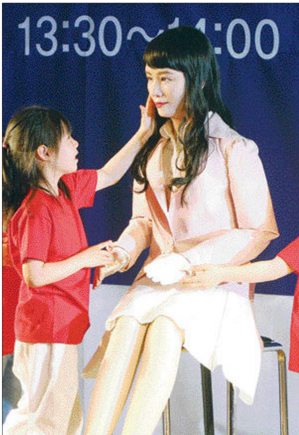
인조인간 로봇 '에버원' 한국생산기술연구원 국내최초로 개발한 인조인간 로봇 '에버원'. 어린이날을 앞두고 4일 서울 교육문화회관에서 공개된 이 로봇은 사람의 얼굴을 똑같이 닮았으나 표정도 짓고, 수천 개의 문장도 말할 수 있다. /연합뉴스
