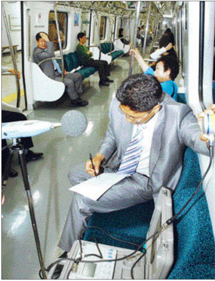
본사 취재팀이 개통 2주년을 맞은 광주지하철 1호선 진동차 내에서 소음과 진동을 측정하고 있다.
