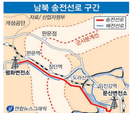
전력 공급량은 10만kW급으로 한전은 향후 입주기업과 전력수요가 커지면 변압기를 늘려 최대 20만kW까지 공급을 확대할 방침이다. /연합뉴스
