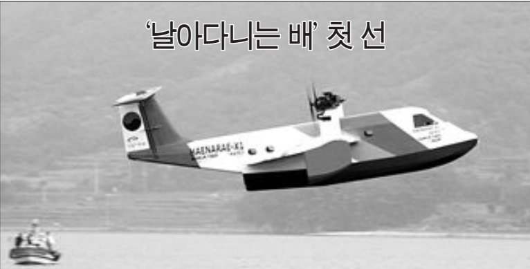
'날아다니는 배' 위그선(WIG Craft)이 29일 경남 고성군 당항면에서 첫 선을 보였다. '한국해양연구원'이 설계하고 (주)한국화이바가 제작을 맡은 6인승의 이 위그선은 길이 12.5m·폭 10.5m·높이 4m 크기. 날개 위에 엔진이 달려 있으며 수면 위에서 뜬 상태에서 최고 시속 120km로 달릴 수 있다. /연필뉴스
