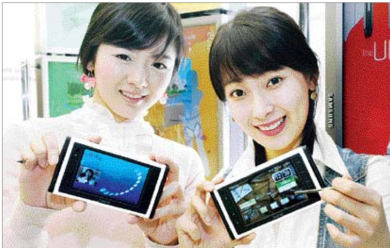
삼성전자는 10일 13Mbps급 속도로 초고속 무선인터넷을 이용할 수 있는 와이브로(WiBro) 커뮤니케이터(SWT-W100K)를 출시했다. 이 제품은 내비게이션과 PMP, 지상파 DMB 등 다양한 기능을 하나의 단말기에 구현했고 DMB방송과 동영상도 고화질로 볼 수 있다.
