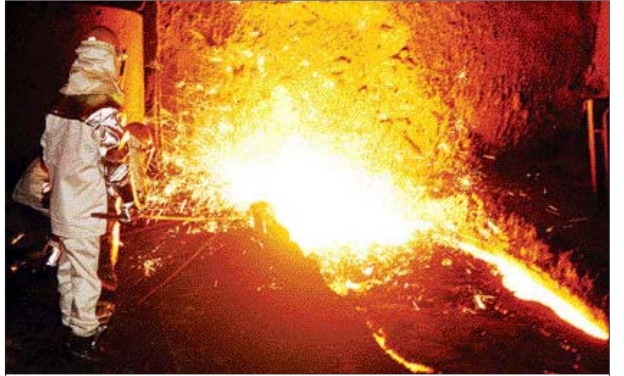
포스코 광양제철소 3고로가 일본 오이타 2고로에 비해 크기는 적지만 일일 최대 출선량 1만4천350t을 기록, 세계 신기록을 수립했다. 3고로에서 쇳물(선철)을 빼내고 있는 장면. <광양제철소 제공>
