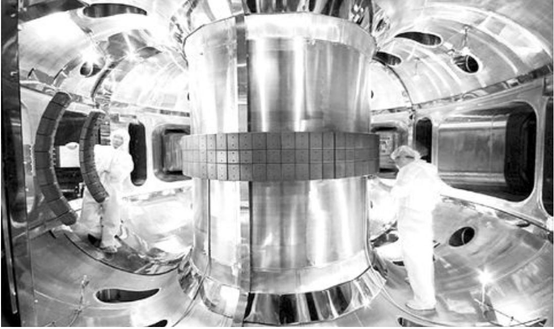
15일 첫 불꽃을 밝히는 데 성공한 한국형 핵융합로 'K-STAR'의 내부. 태양이 빛을 내는 원리인 핵융합 반응을 인공적으로 일으켜 핵융합 에너지를 얻기 때문에 '인공태양'으로도 불리는 핵융합로는 지난 1995년부터 모두 3천90여일이 투입돼 지난해 9월 완공됐다.
