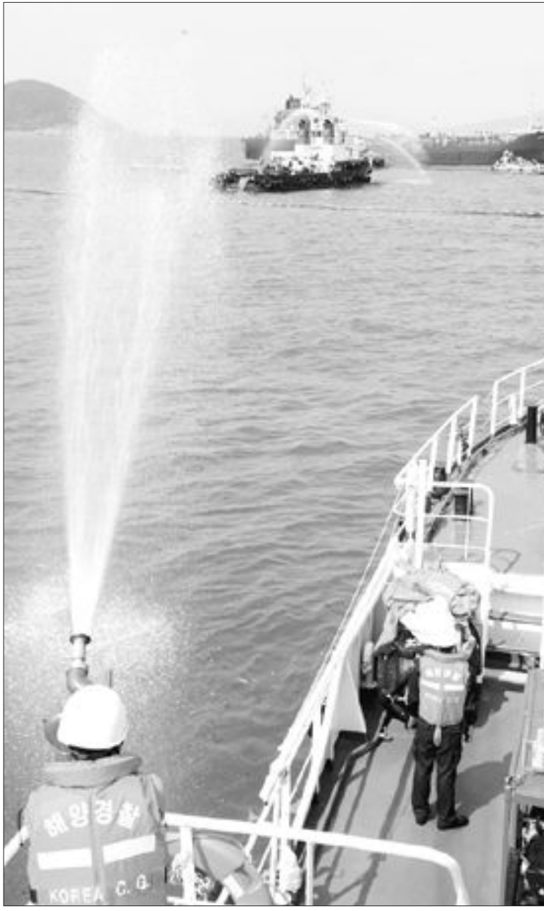
19일 오후 여수해경, 해양공단, GS칼텍스 등이 참여한 가운데 진행된 해양오염 방제 을지훈련에서 참가자들이 호스를 이용해 유(油) 처리제를 뿌리고 있다. /위직기자 jwji@kwangju.co.kr
