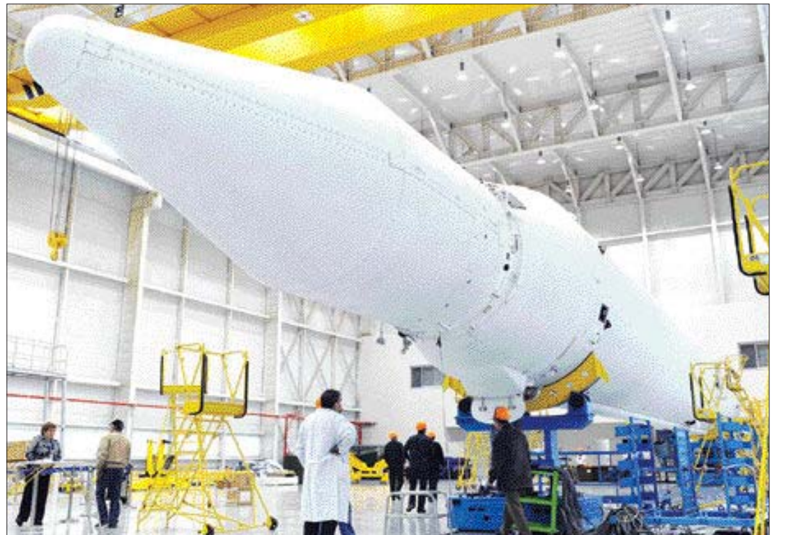
20일 고흥 나로우주센터 발사체종합조립동에서 러시아 기술로 제작된 1단 로켓과 항우연이 자체 개발한 2단 로켓의 결합 시험이 이뤄졌다. /고흥=최한배기자 choi@kwangju.co.kr
