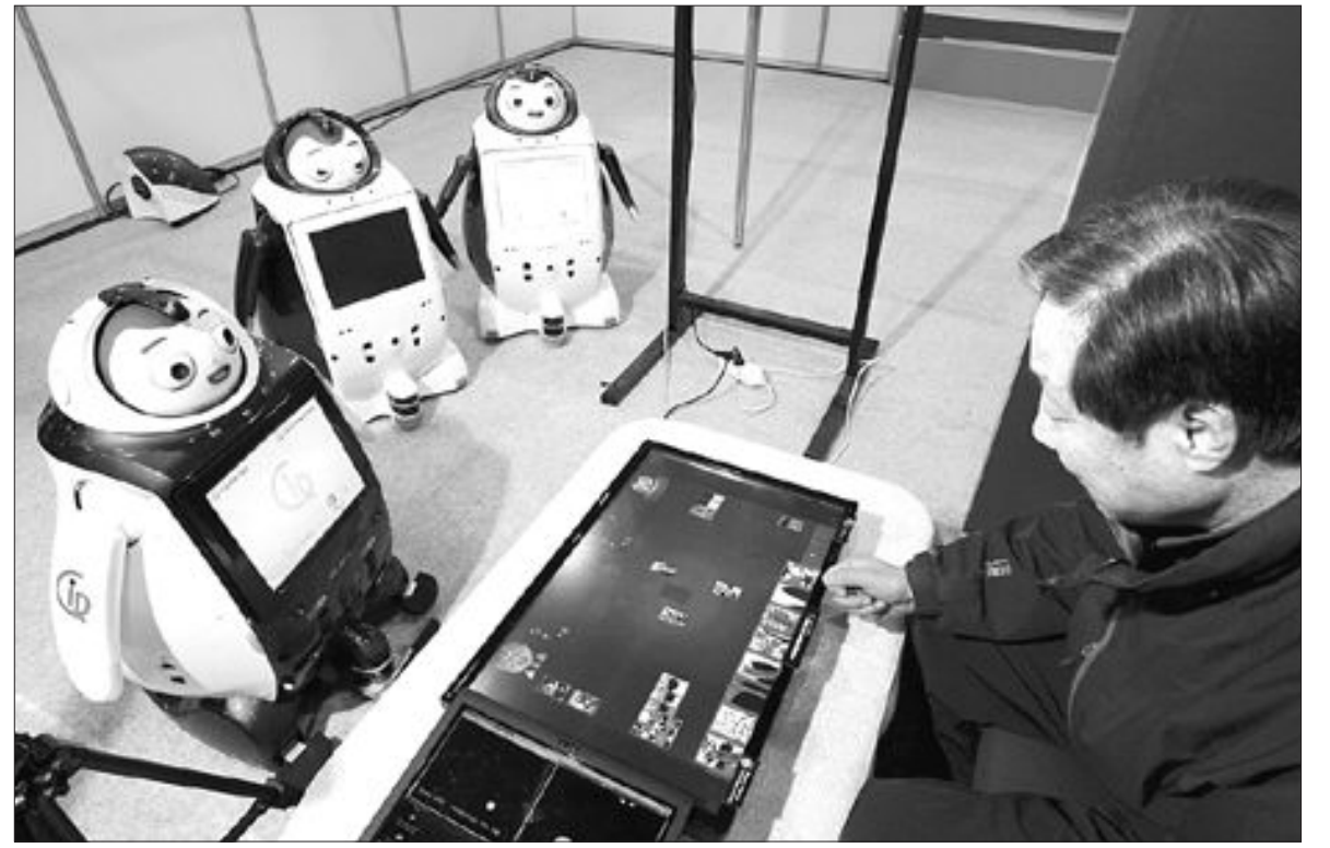
고스톱 치는 로봇 19일 서울 양재동 aT센터에서 열린 제11회 프론티어산업 기술교류회에서 노인이 지능형로봇 '실벗'과 고스톱을 치고 있다. 한국과학기술연구원(KIST)이 개발한 실벗은 '실벗세대(노년층의 벗)'의 줄임말로, 음성과 표정으로 감정을 표현하며 3m 거리에서도 주인의 음성과 위치를 파악해 움직인다. /연합뉴스
