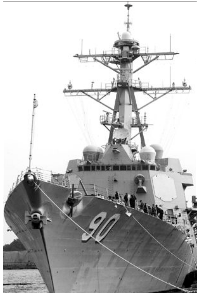
동해 입항한 미 이지스함 '채피함' 12일 동해항에서 공개된 미국의 최신 이지스 구축함인 채피함(9천200t급). 채피함에는 반경260km 내의 모든 물체를 식별할 수 있는 4개의 고정식 레이더가 장착돼 있어 북한이 인공위성이나 미사일을 발사하면 즉각 탐지가 가능하다.
