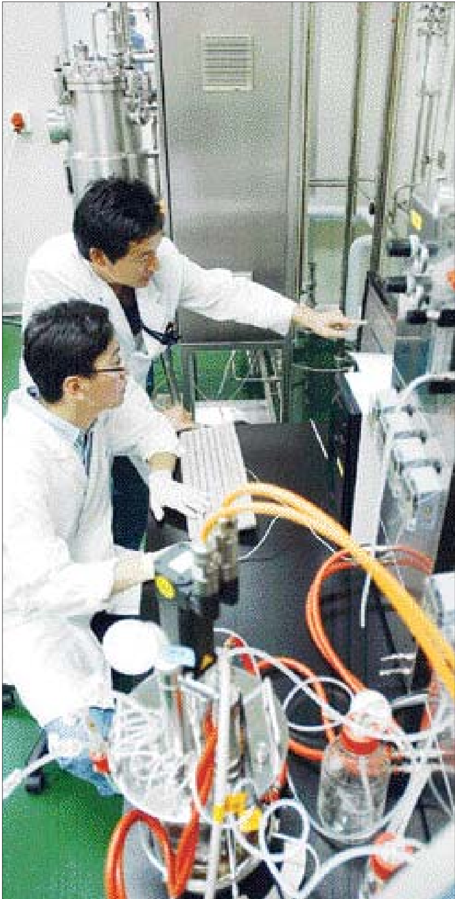
전남도 생물의약품연구센터 연구원들이 공정개발실에서 백신 등 신약을 개발하기 위해 배양한 미생물을 발효조에 연결시킨후 분석결과를 모니터링하며 관련 연구에 몰두하고 있다.
