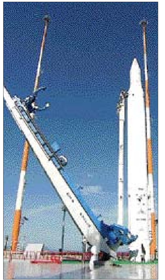
교육과학기술부는 오는 30일로 예정된 국내 최초 우주발사체 나로호(KSLV-I)의 발사일이 다가옴에 따라 정부 차원의 종합 점검을 실시하고 있다. 사진은 발사대 인증시험 중 나로호에 연료와 산화제를 주입한 후 발사를 위해 이렉터(erector) 분리를 시험하는 장면.(영하 185°C의 액체산소가 주입되어 발사체 표면에 얼음이 얼어있다.) /연합뉴스
