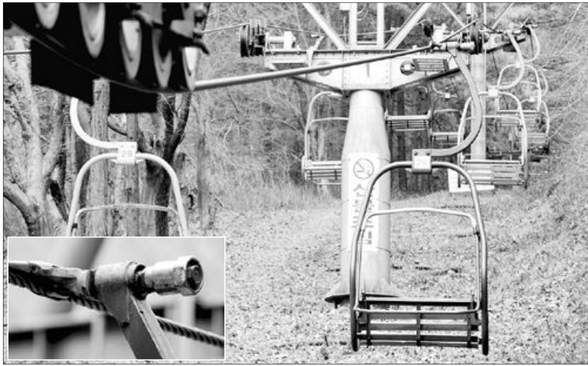
지난 13일 광주 지산유원지에서 리프트와 쇠줄을 잇는 고정 연결장치가 풀리면서 리프트끼리 부딪쳐 노인 2명이 중상을 입었다. 왼쪽 아래는 리프트와 쇠줄을 고정연결하는 장치.
