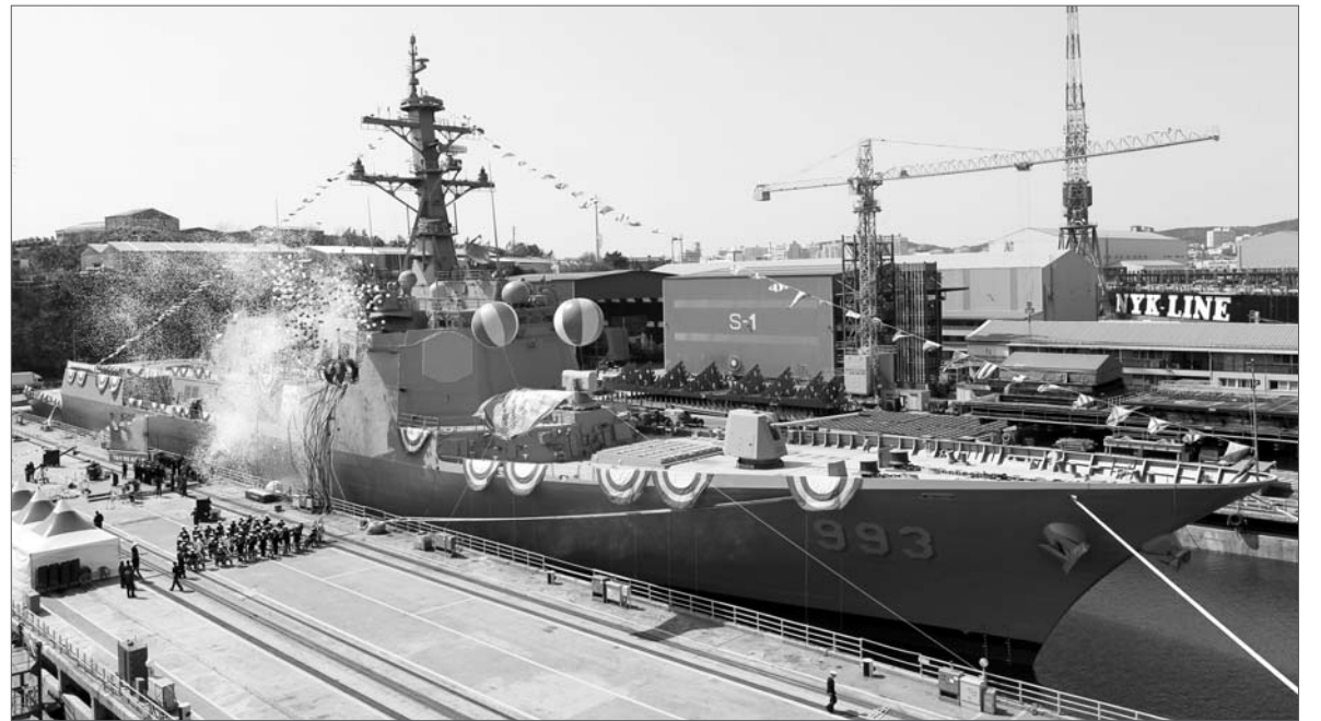
이시스 구축함 '서해 류성룡함' 진수 현대중공업은 24일 세계 최고 수준의 대함(對艦), 대공(對空), 대전(對潛) 전투능력을 갖춘 '서해 류성룡함'(KDX-III) 진수식을 가졌다. 류성룡함은 현대중공업이 독자 기술로 설계하고 건조한 우리나라 세 번째 이시스 구축함이다. 길이 165.9m, 폭 21m, 높이 49.6m, 7천600급으로 SPY-1D 레이더 등으로 구성된 이시스 전투체계를 탑재, 1천여개의 표적을 동시에 탐지하거나 추적하고 그 중 20여개의 표적을 동시에 공격할 수 있는 최신에 전투함이다. /연합뉴스
