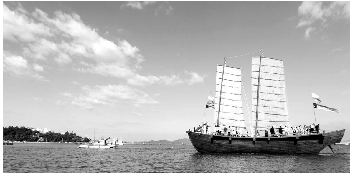
조선시대 조운선 복원 진수 국립 해양문화재연구소는 1797년 무렵에 나온 조선시대 선박 도해서인 ‘각선도본’(各船圖本)에 실린 도면과 다양한 고문헌 자료를 토대로 길이 24m·너비 7.5m·깊이 3.3m의 조운선(漕運船)을 복원, 지난 19일 첫 항해에 나섰다. 조운선은 조선시대 삼남 지방에서 세금으로 거둔 곡물을 뱃길로 운반했던 선박이다. /연합뉴스
