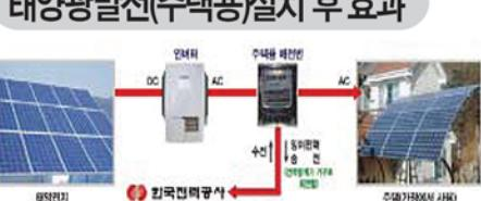
2KW 용량의 태양광 발전 설치시 월평균 약 240~300KWh의 전력을 생산 가능하고 사용량에 따른 전기료를 절약합니다.
