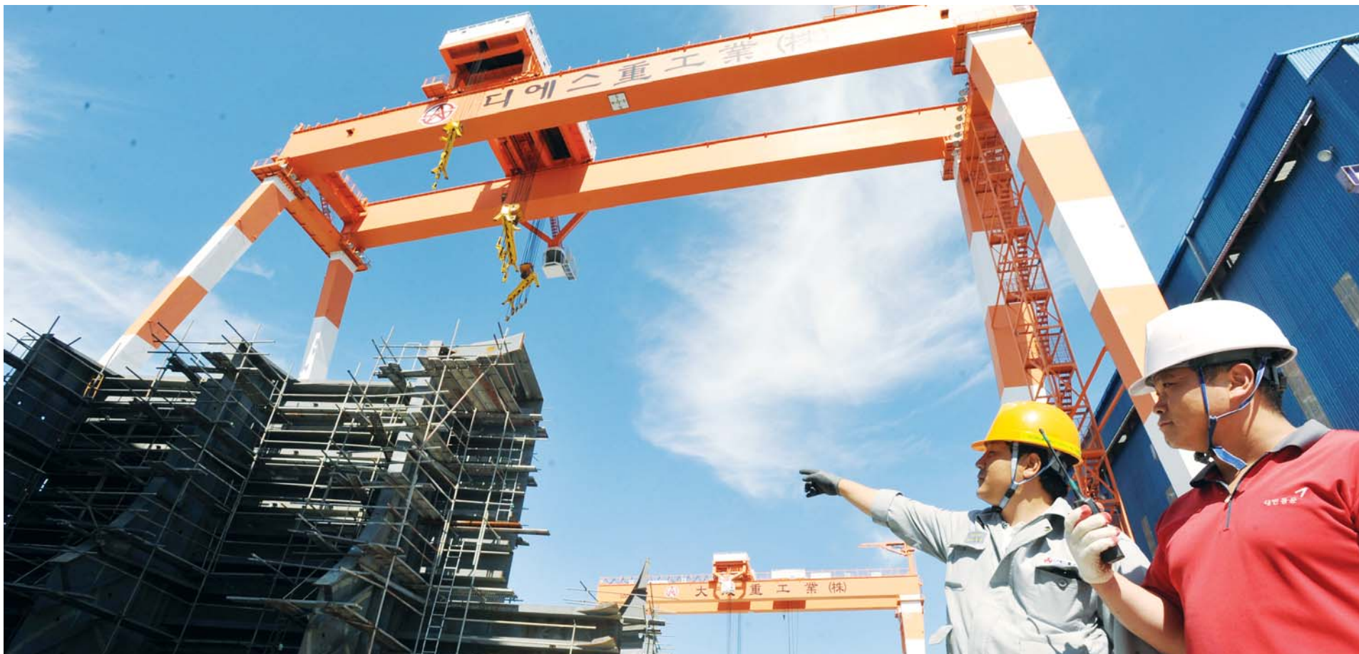
디에스중공업의 핵심시설인 육상 최대 500t 규모의 골리앗크레인이 대형블록 작업을 위해 이동하고 있다.
