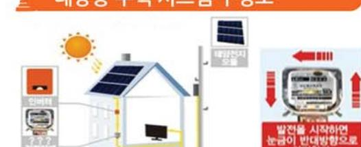
태양광 시스템은 전기를 생산하는 태양광 모듈과 구조물, 전력을 변환시키는 장치인 인버터 등으로 구성됩니다. 이렇게 발생된 전기는 자가용으로 우선 사용되며 남은 전력은 한국전력공사로 역전송 하여 역전송 된 만큼 전기료 사용량이 차감되어 전기요금 절약 효과가 있습니다.
