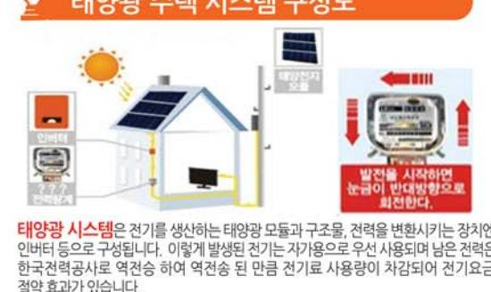
태양광 시스템은 전기를 생산하는 태양광 모듈과 구조물, 전력을 변환시키는 장치인 인버터 등으로 구성됩니다. 이렇게 발생된 전기는 자가용으로 우선 사용되며 남은 전력을 한국전력공사로 역전송 하여 역전송 된 만큼 전기료 사용량이 차감되어 전기요금 절약 효과가 있습니다.
