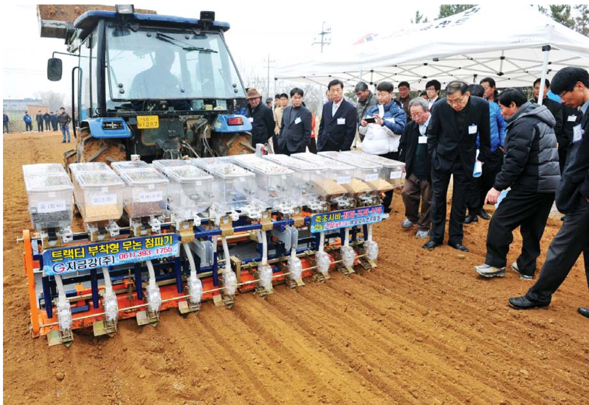
“뭇자리 없이 벼농사 지어요” 이노비즈(기술혁신형) 기업인 G금강(대표이사 김식은)은 지난 2일 광주시 북구 첨단산단 내 지금강 본사에서 새로 개발한 ‘트랙터 부착형 무논 점파 파종기’ 설명회를 열었다. 이 제품은 뭇자리 없는 벼농사와 노동력·농자재비용을 17%가량 절감할 수 있는 신기술 농기계로 농림수산식품부의 연구개발(R&D) 과제로 선정돼 개발됐다. 이날 설명회에는 전국에서 모인 300여 명이 신기술 ‘점파 파종기’의 씨뿌리기 등을 지켜봤다. /김진수기자 jeans@kwangju.co.kr
