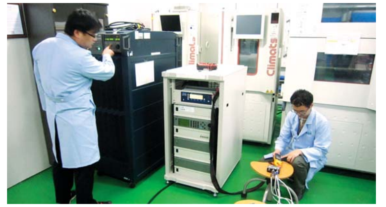
전자부품연구원 광주본부 연구원들이 냉장고용 콤프레서 인버터에 전류부하 시 열충격 시험을 하고 있다. (전자부품연구원 광주본부 제공)
