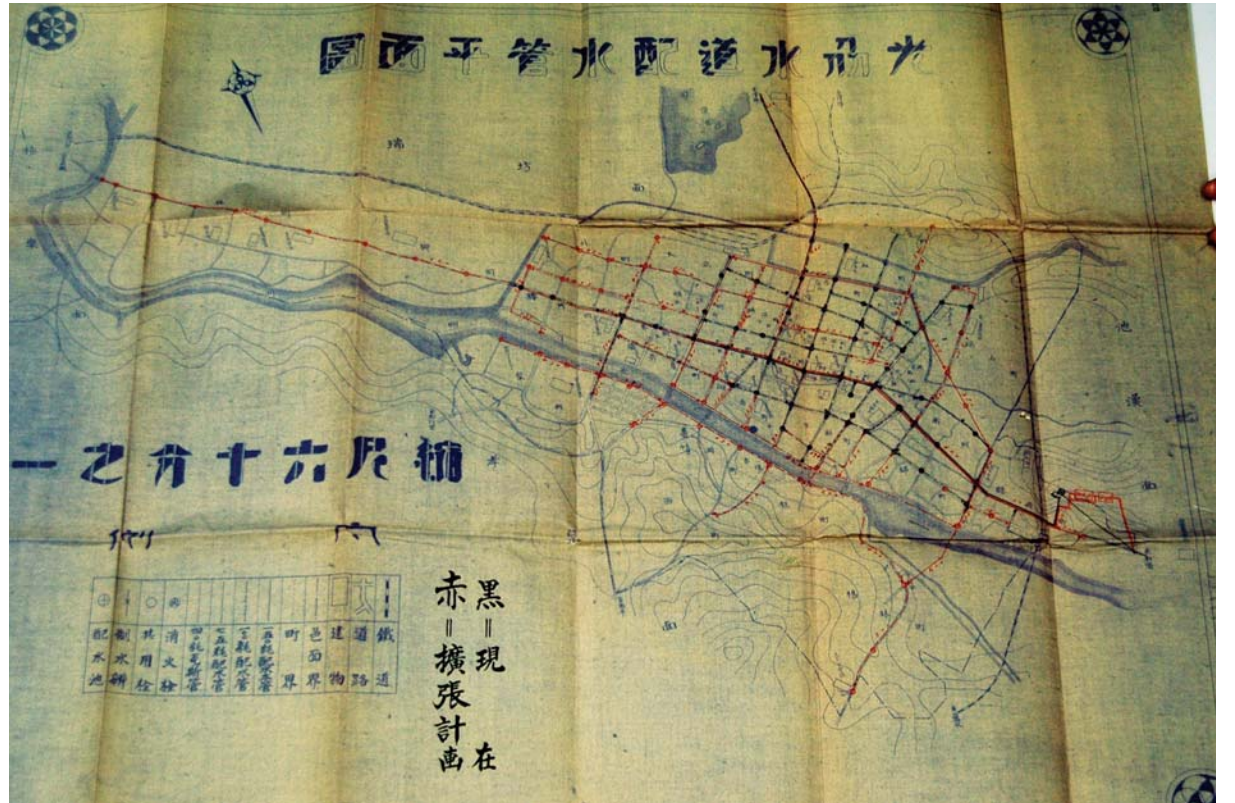
1933년 조선총독부 상수도 국고보조 서류의 광주수도배수관평면도. 1920년 당시 광주면 주요도로를 따라 부설된 수도는 검은색 선이며, 광주면은 1935년부터 42만원의 거액을 들여 3개년 계속사업으로 구도심 내 나머지 도로와 광주천 건너편까지 수도 배수관(확장구간은 붉은색 선)을 놓으려고 시도하고 있다. 제1수원지에서 뿜어나온 배수관은 지금의 조선대 부근 구릉지를 거쳐 시가지로 향하고 있으며, 경양방죽과 광주천의 형태도 살펴볼 수 있다.
