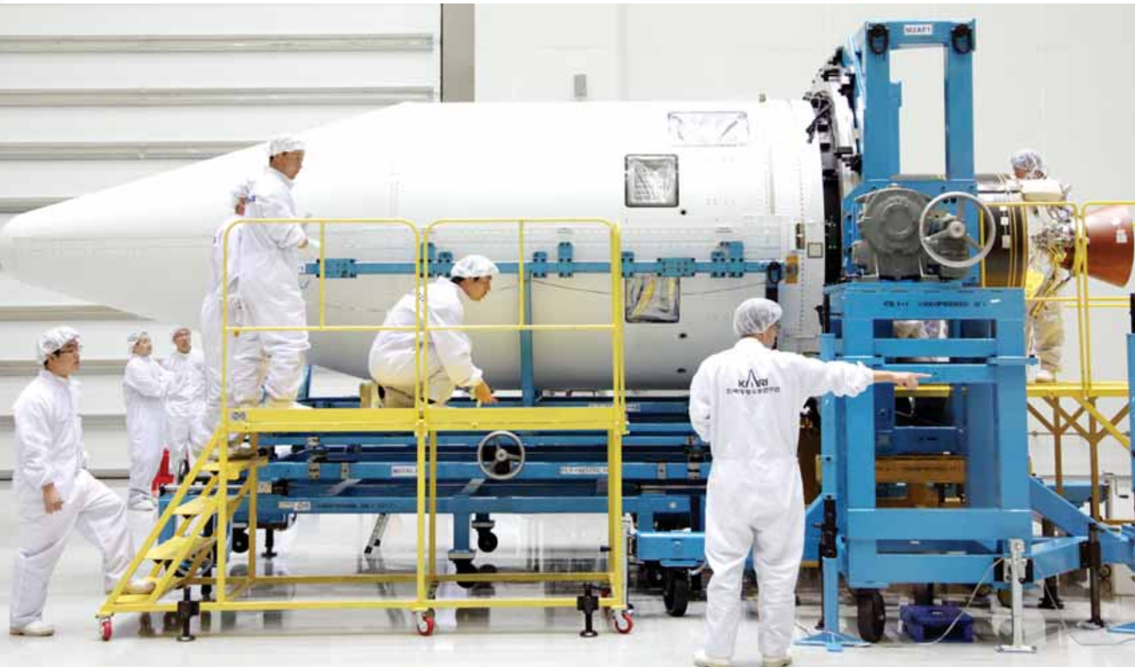
나로호 3차 발사를 앞두고 고흥 나로우주센터가 최종 발사 리허설을 하는 등 막바지 작업을 벌이고 있다. 사진은 나로호 상단 조립을 위해 연구원들이 페어링을 옮기고 있는 모습. <나로우주센터 제공>
