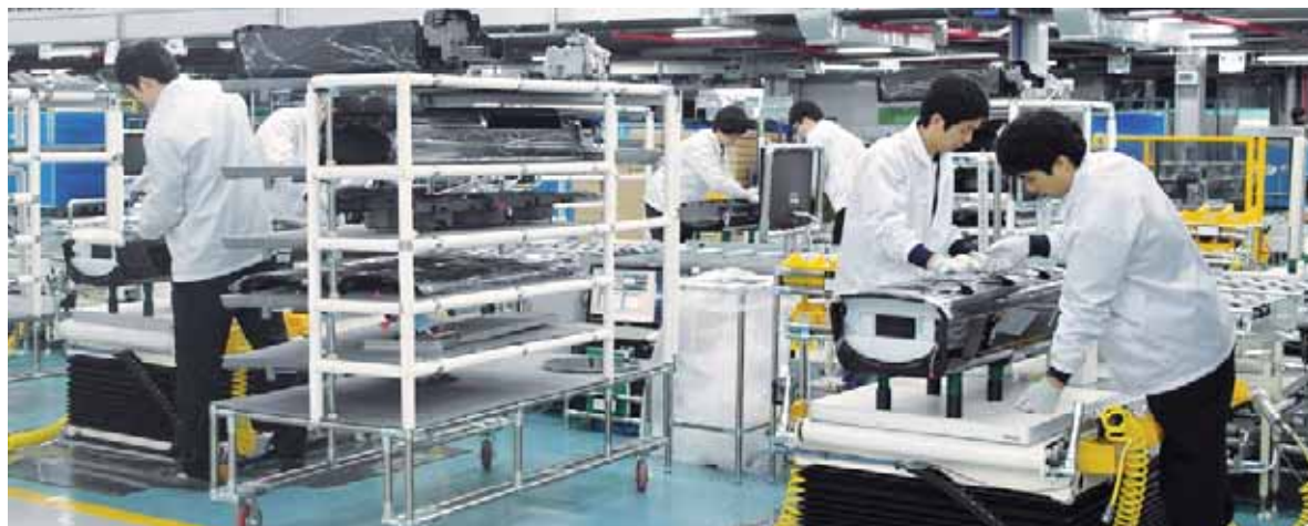
삼성전자 광주사업장 직원들이 2인1조로 에어컨을 조립하고 있다. 광주사업장은 지난해 말 40년 만에 컨베이어벨트를 걷어내고 모듈생산방식(MPS)을 도입했다. <삼성전자 광주사업장 제공>
