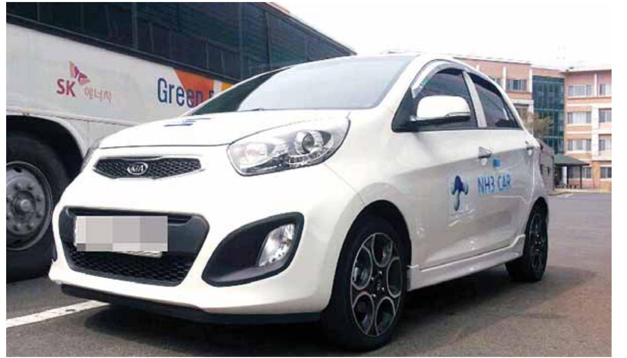
암모니아로 달리는 자동차 한국에너지기술연구원의 김종남·우영민 박사 연구팀이 국내 최초로 개발한 암모니아·가솔린 혼소 자동차. 액상 암모니아(NH 3 )와 가솔린(휘발유)을 혼합한 연료를 사용해 이산화탄소(CO 2 ) 발생을 크게 줄였다. /연합뉴스
