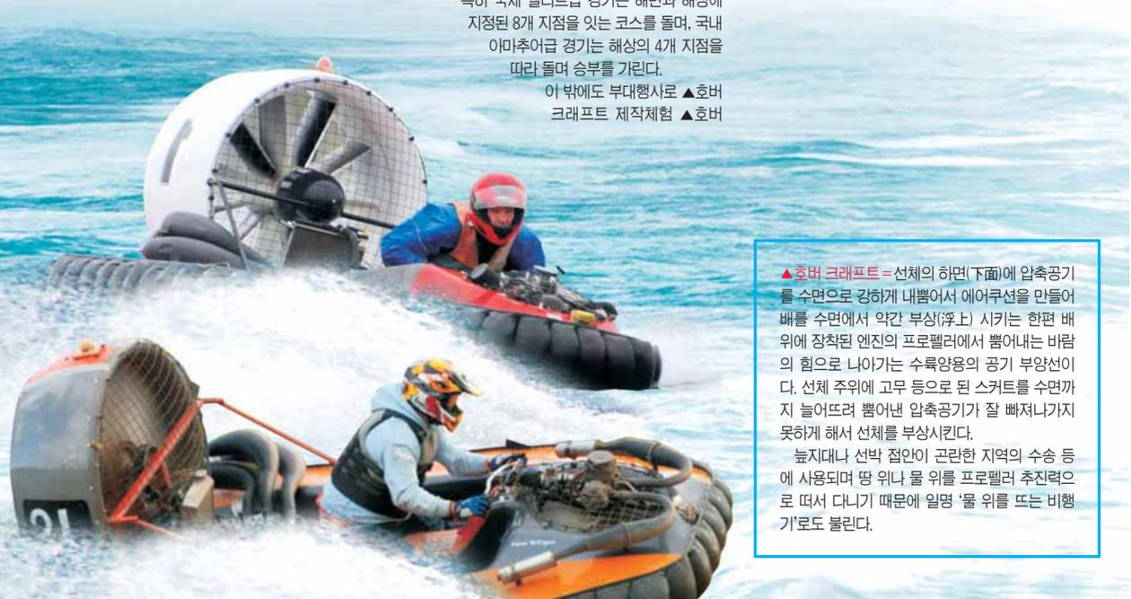
▲호버 크래프트=선체의 하면(下面)에 압축공기를 수면으로 강하게 내뿜어서 에어쿠션을 만들어 배를 수면에서 약간 부상(浮上)시키는 한편 배 위에 장착된 엔진의 프로펠러에서 뿜어내는 바람의 힘으로 나아가는 수륙양용의 공기 부상선이다. 선체 주위에 고무 등으로 된 스킵트를 수면까지 늘어뜨려 뿜어낸 압축공기가 잘 빠져나가지 못하게 해서 선체를 부상시킨다.
