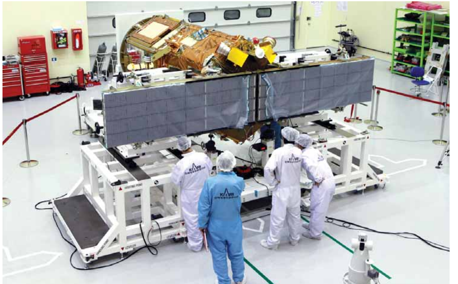
다목적실용위성(아리랑) 5호의 영상레이더(SAR)를 탑재한 뒤 연구원들이 기기 성능 등을 시험하고 있다. (한국항공우주연구원 제공)
