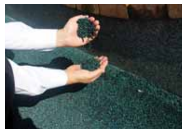
상·중·하 방파제 3곳의 노면에 페타이어 또는 EPDM(합성고무)의 자재로 시공된 우레탄 탄성 포장기 부식되면서 오염을 부추기고 있다. 우레탄으로 포장된 곳곳이 갈라져 있었고 부서진 까만 고무 알갱이들이 한 움큼씩 잡힐 정도였다.(사진 아래) 이와 관련 군은 지난 2011년 우레탄 포장을 일부 보수하기도 했으나 별다른 성과가 없었던 것으로 알려졌다.
