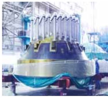
한빛 3호기에 들어갈 원자로 헤드의 모습. 원자로 헤드는 제어봉을 통해 원자로 내 핵반응을 제어하는 역할을 담당한다. <한빛원자력본부 제공>
