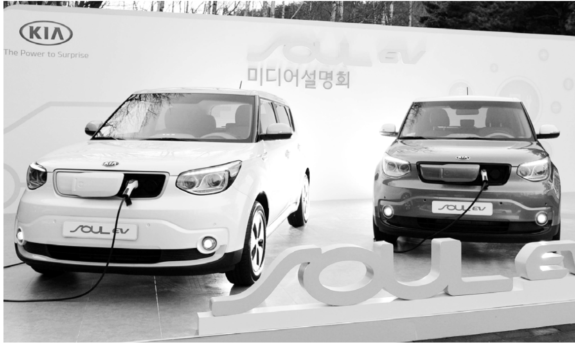
지난 11일 경기도 화성 톨링힐스 호텔에서 공개된 전기차 '쏘울 EV'. 작년 출시한 '올 뉴 쏘울'을 기반으로 개발된 쏘울 EV는 27kWh 고용량 리튬이온 배터리를 장착해 1회 충전으로 최대 148km까지 주행할 수 있다. <기아차 제공>
