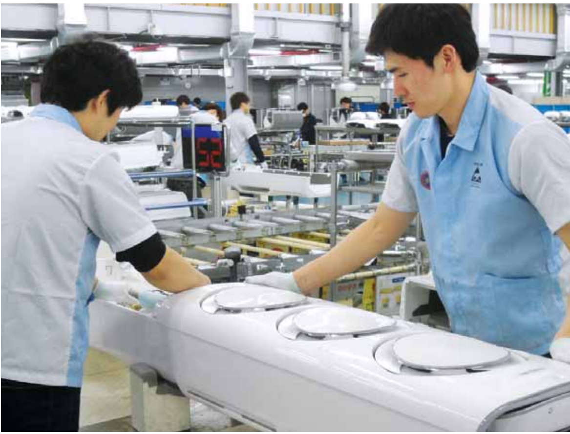
14일 삼성전자 광주사업장 에어컨 제조현장에서 작업자들이 모듈생산시스템에 따라 에어컨 실외기를 놓힌 채 조립하고 있다. (삼성전자 제공)
