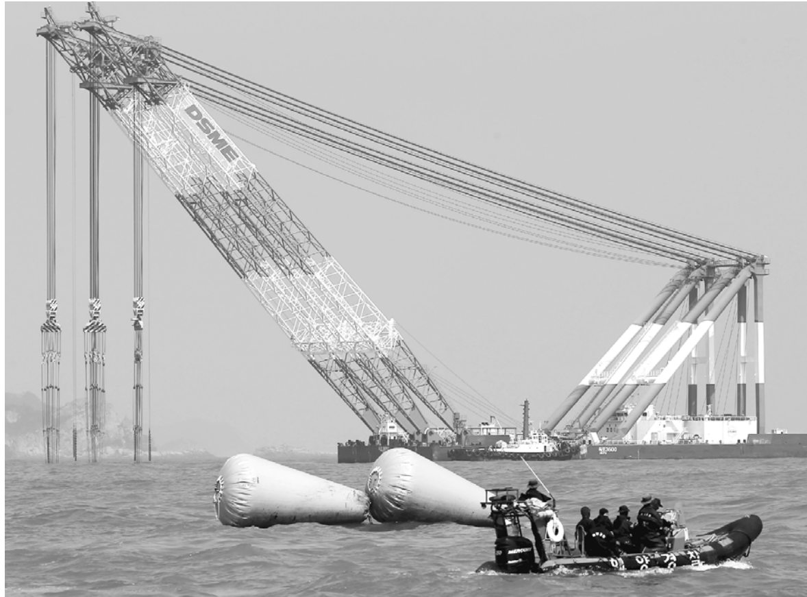
2012 오후 세월호 사고 현장인 진도군 조도면 병풍도 앞 해상에서 침몰 선박 부양을 위한 리프트백(공기 주머니)이 설치된 모습이다. 뒤쪽으로는 선박 인양을 위해 대기 중인 대형크레인의 모습이 보인다. /연안뉴스
