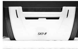
실외용으로 가로등에 설치해 모기나 하루살이, 깔다구 등을 유인해 잡는 ‘스카이 제퍼’는 유인된 해충을 내부에 장착된 팬으로 흡입해 커터기로 분쇄한 후 방출하는 포충기다. 자동으로 작동하고 한 번 설치하면 사후관리가 편리하다.
