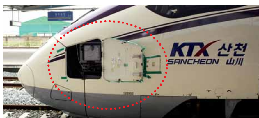
2일 오후 12시5분 서울 용산역을 출발한 KTX가 출발한 지 16분 만에 고장에 따른 저속 운행으로 지연도착했다. 사진은 파손된 위셔액 주입구 덮개를 청테이프로 붙여서 고정된 모습(붉은 점선).
