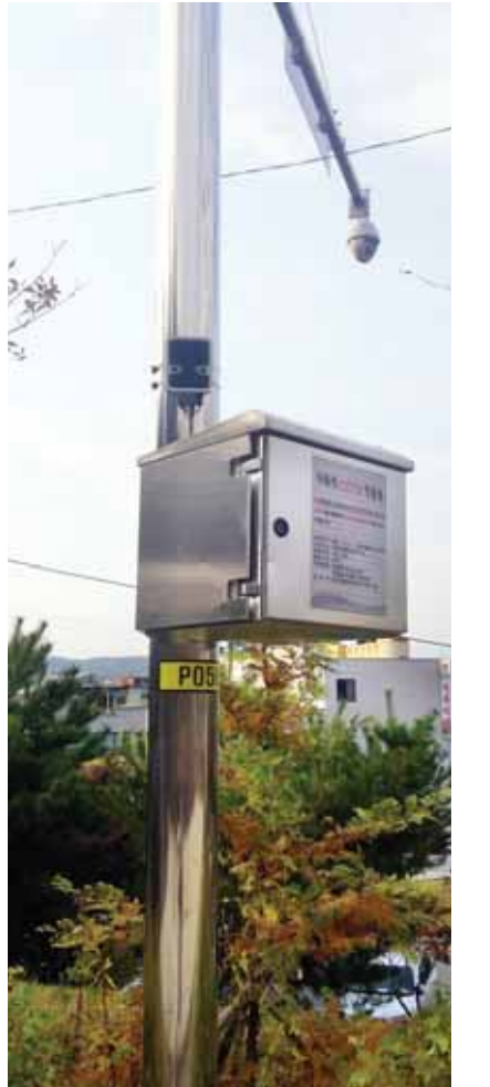
장성군이 최근 CCTV에 설치한 이상음원 탐지 장치. CCTV 영상을 분석해 화재, 폭발, 재난 사고에서 발생하는 음원을 탐지해 경보를 울리도록 설계됐다. (장성군 제공)
