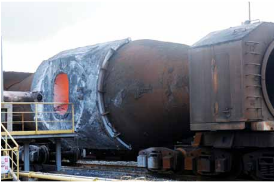
광양제철소 직원들이 용선운반차의 승온 패턴 정립을 위해 현장을 확인하며 서로 의견을 나누고 있다. 오른쪽은 수리를 마치고 승온 준비 중인 용선운반차. <광양제철소 제공>
