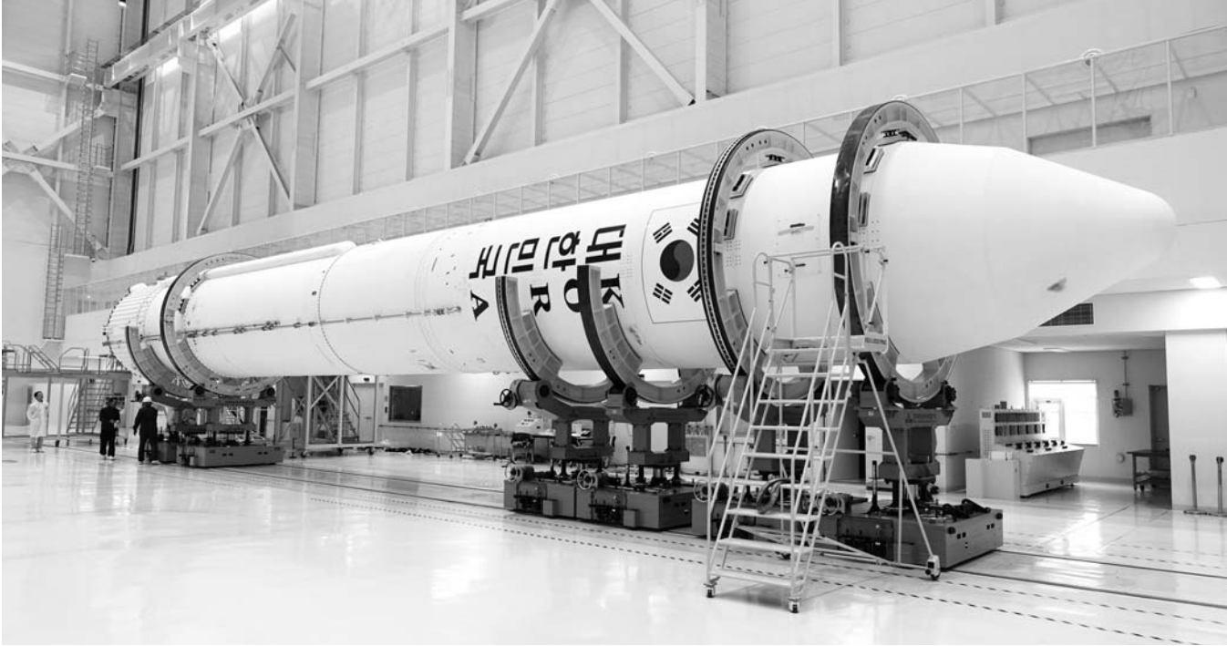
과학기술정보통신부와 한국항공우주연구원이 지난 6일 전남 고흥군 나로우주센터에서 시험발사체 비행모델(FM)을 공개했다. 시험발사체는 누리호에 쓰이는 75t급 액체엔진의 성능을 검증하기 위한 것으로, 총 3단으로 구성된 누리호의 2단부에 해당한다. /연합뉴스
