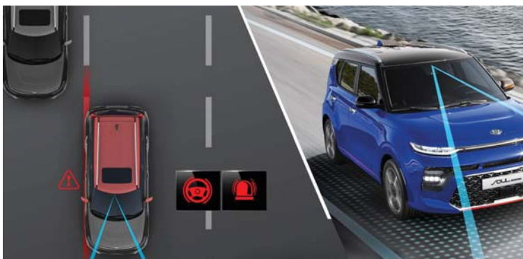
차로를 이탈하게 되면 경고음으로 알려주는 차로이탈방지 보조시스템.
