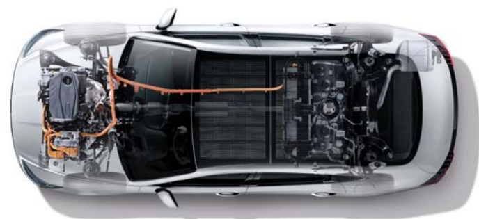
현대차그룹이 세계 최초로 개발한 ASC기술이 적용된 쏘나타 하이브리드 시스템.
