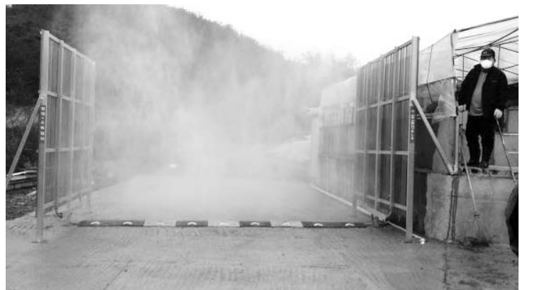
정읍 축산농장 출입구에 설치된 차량 자동소독기.
