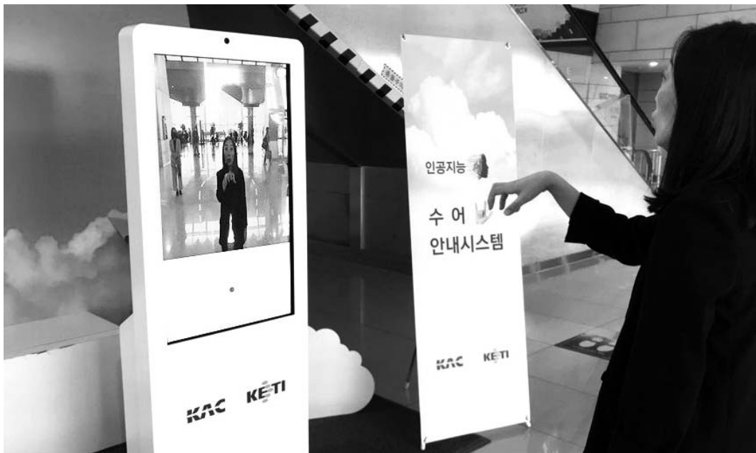
최근 김포 국제공항에 설치된 비마커 방식 수어 안내 시스템 단말기.
