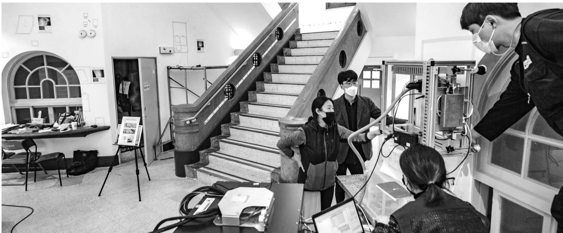
“탄환의 흔적을 찾아라” 14일 오후 광주 동구 옛 전남도청 본관에서 옛 전남도청복원추진단의 조사 위탁을 받은 한국전통문화대 학교기업 컨테크(Con-Tech) 팀이 고주파 투과기인 ‘테라헤르츠 분석기’를 이용해 본관 내부 벽면에 남아있을 탄환의 흔적을 조사하고 있다. /김진수 기자 jeans@
