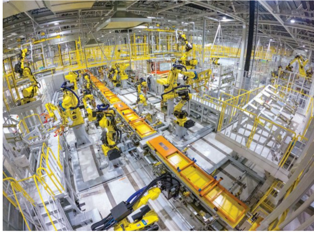
광주글로벌모터스가 5일부터 경형 스포츠 유틸리티 차량의 시험생산에 들어간 가운데 자동차의 뼈대를 만드는 차체 공장에서 로봇 118대가 시험 가동 되고 있다. /김진수 기자 jeans@kwangju.co.kr
