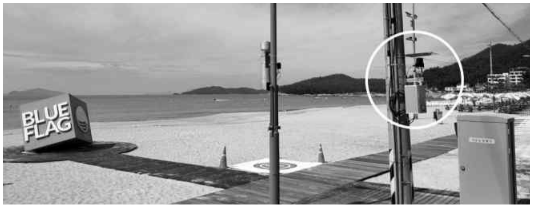
완도 신지명사십리 해수욕장 전신주(원 안)에 설치된 스마트 무인계측기.
