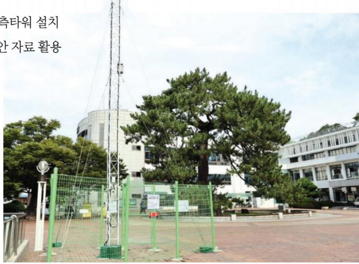
해남군청 앞 수성송과 자동기상관측타워. 자동 센서를 장착한 자동기상관측타워는 풍향, 풍속, 온도, 습도 등 데이터를 수집해 수성송에 대한 청사 철거 전후 변화를 측정하게 된다. <해남군 제공>
