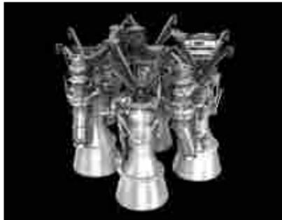
누리호에 장착된 75t급 액체엔진의 연소 시험 장면(위). 75t급 액체 엔진 4기가 묶여(클러스터링) 있는 모습. <항우연 제공>
