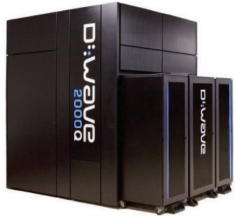
지난 2017년 공개된 2000큐비트 양자 컴퓨터 'D-웨이브 2000Q'. <D wave 웹사이트 갈무리>
