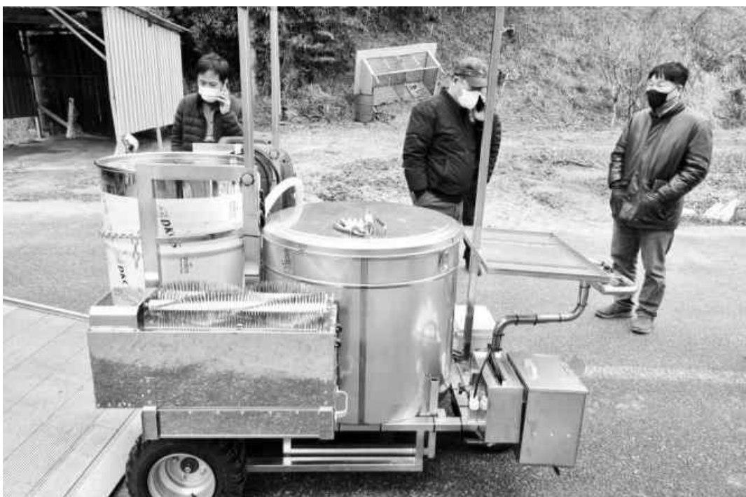
수평 운반차에 꿀을 뜨는데 필요한 탈봉기·채밀기·발전기·비상 차단기가 모두 탑재돼 있는 채밀대차. 양봉농가의 인력난 해소에 큰 도움이 된다. <장성군 제공>
