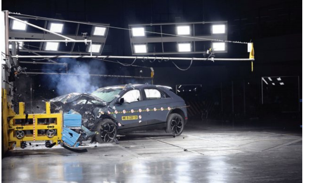
현대차·기아 남양연구소 안전시험동에서 현대차의 아이오닉 5를 대상으로 충돌 안전 평가가 진행되고 있다.
